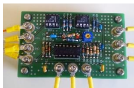
学生が製作した 筋電計の回路
