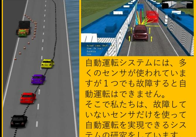
自動運転システムには、多くのセンサが使われていますが1つでも故障すると自動運転はできません。そこで私たちは、故障していないセンサだけを使って自動運転を実現できるシステムの研究をしています。
