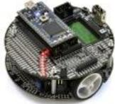
とAndroidタブレット
